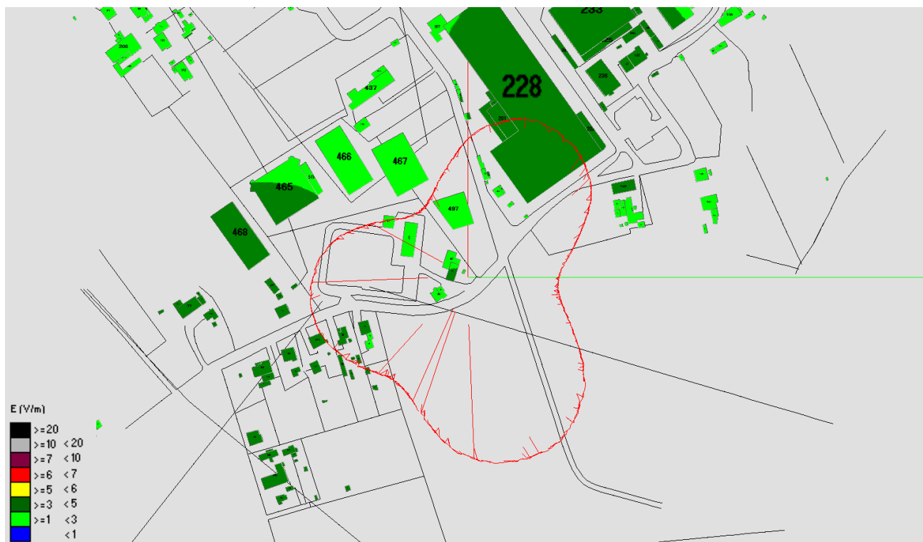
Fig. 38 Impatto elettromagnetico – Zona Via dei Tavi Centrale ENEL – Vista dall'alto
